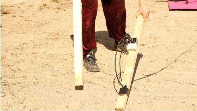
Bâton équipé d'un micro-contact ; les vibrations sont transmises aux assises du public.
